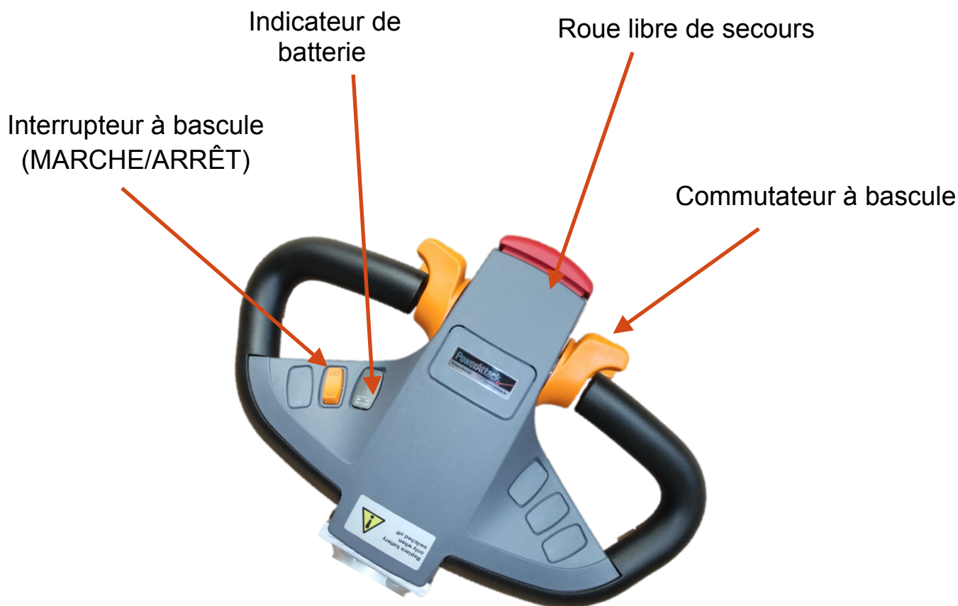
Tête de timon avec commutateurs à bascule et roue libre de secours
